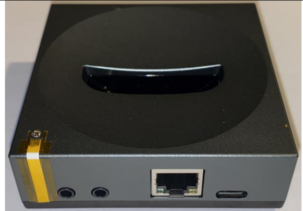
Bild 9.6: UCR2-Dock - Verdrahtung der externen Power-IR-LED außen
