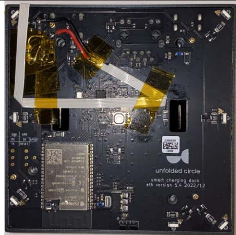
Bild 9.5: UCR2-Dock - Verdrahtung der externen Power-IR-LED auf LP-Unterseite
