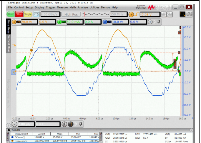
Abb. 7.21: 20210429_Royer_24Vin_65mAin_Usek1_212V@100k_108kHz_Uc_20Vdiv_Ic_50mAdiv_Usek_10Vdiv.png Messung ohne Rs und Parallel-Cs: die Schwingung aus trr ist deutlich
